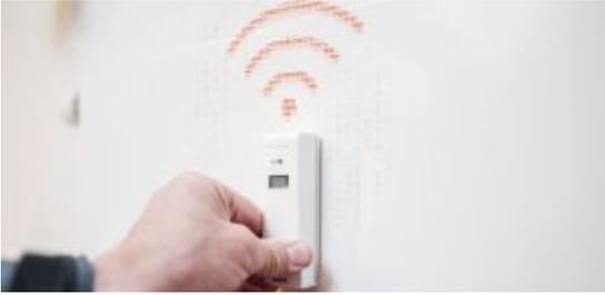
Heizkostenverteiler nach dem Verdunstungsprinzip - sogenannte Verdunster-Röhrchen - sind zwar gesetzlich noch zugelassen, werden aber seit Jahren verstärkt von elektronischen Geräten abgelöst, heutzutage mit komfortabler Funkübertragung der Ablesewerte. Informieren Sie sich jetzt und rüsten auf modernste Technik um. Das ist günstiger als Sie denken!
